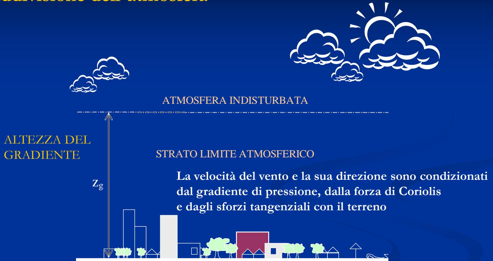
L'altezza del gradiente dipende dalla scabrezza del suolo espressa dal parametro  $z_0$  detto **LUNGHEZZA DI RUGOSITÀ**
